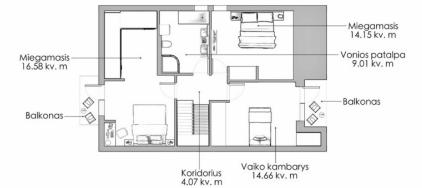
Namo 2 aukšto patalpų išdėstymo planas
